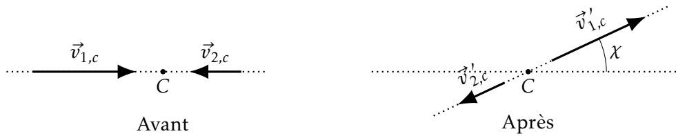
FIGURE 2.1 – Collision à deux ou trois dimensions dans le référentiel du centre de masse.
