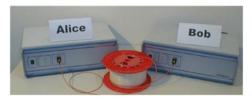
FIGURE 1.9 – Système commercial de cryptographie quantique développé par la firme genèvoise ID-Quantique (http://www.idquantique.com/).
