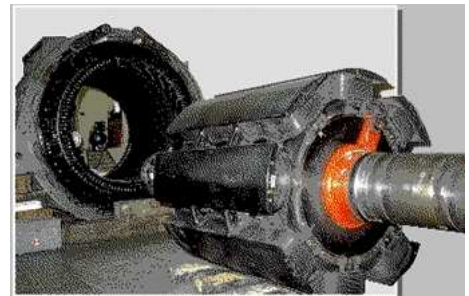
FIG. 11 – Alternateur de puissance
